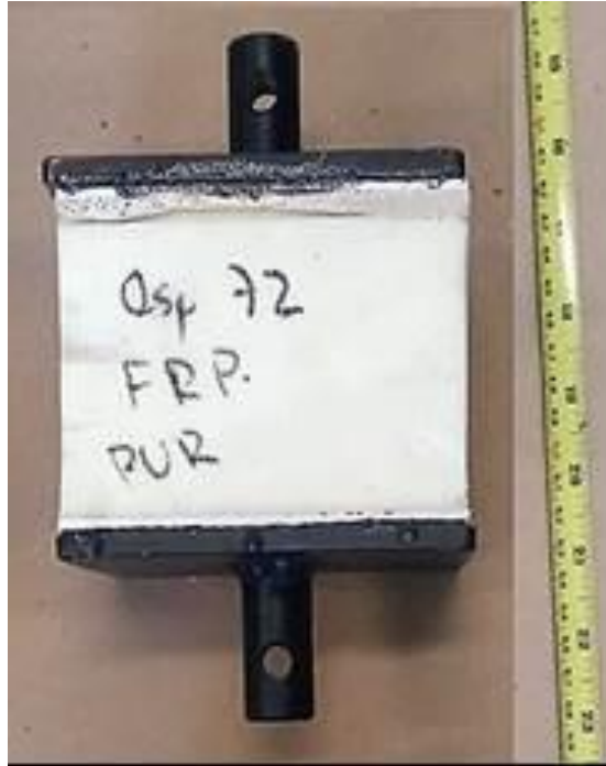
Figura 1. Probeta para el ensayo de tensión.
