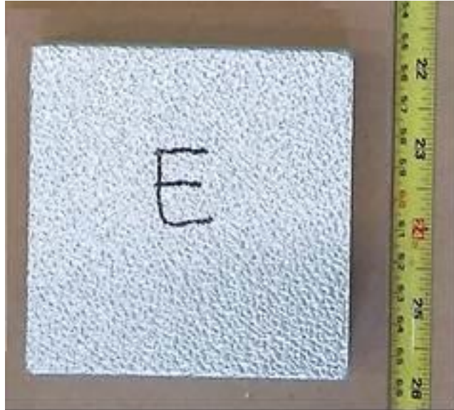
Figura 1. Probeta para el ensayo de estabilidad dimensional.
