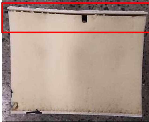
Figura 2. Placa de poliuretano FRP/FRP espesor 72 mm, después de salir del ensayo de cambio dimensional a 80 °C y 168 horas.
