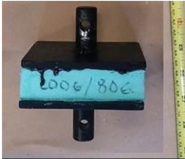
Figura 1. Probeta para el ensayo de tensión.
