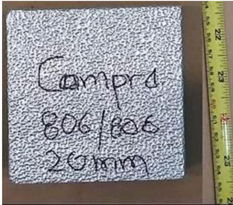
Figura 1. Probeta para el ensayo de compresión.
